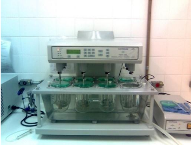
Figura 19 – Dissolutor Metrolab com capacidade para oito cubas de 400 mL cada, utilizada para a liberação da aloína a temperatura de 37 °C.
