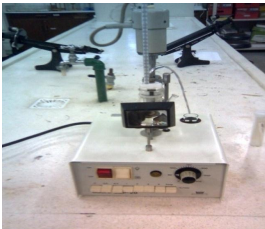
Figura 10 – Aparelho utilizado para determinar o ponto de fusão da aloína (UFPr, 2008).
