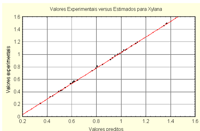
FIGURA 14. Valores observados versus valores preditos para a xilana, normalizados pelo sua concentração inicial na madeira (Modelo Modificado).
